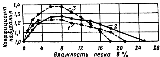
Рис. 3.5. Коэффициент набухания песков с различной влажностью (обозначения те же, что и на рис. 3.4)
