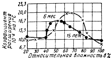
Рис. 7.26. Коэффициент линейного термического расширения цементного камня в разном возрасте
