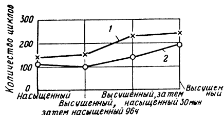
Рис. 7.11. Зависимость между состоянием заполнителей перед замесом и количеством циклов замораживания и оттаивания до достижения 25% потери в весе образцов
