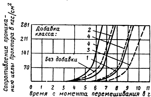
Рис. 2.14. Влияние различных пластифицирующих добавок на сроки схватывания бетона
