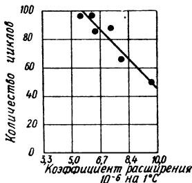
Рис. 7.28. Зависимость между коэффициентом линейного термического расширения бетона и количеством циклов нагрева и охлаждения, необходимым для снижения величины предела прочности при изгибе на 75%
