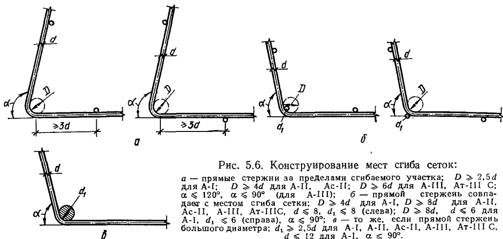
Рис. 5.5. Рекомендуемые очертания гнутых сеток.
