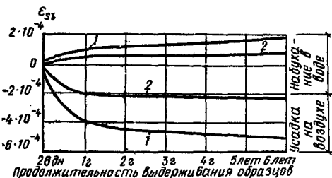
Рис. 1.35. Усадка и набухание 1 — бетона; 2 — железобетона
