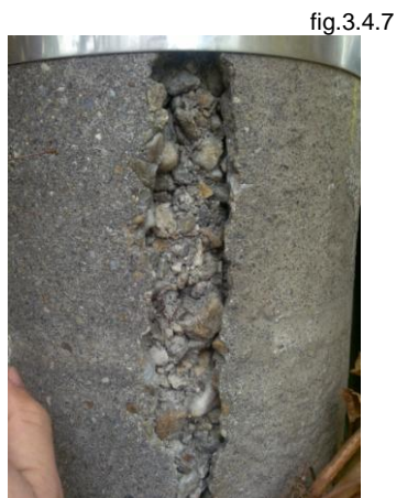
Defecte de execuție. Stâlp prefabricat, din beton armat
